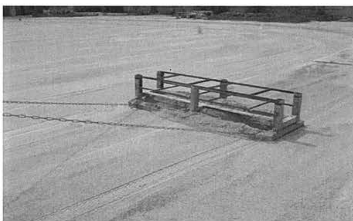
図8-3 軽車両でのほぐし(重量調整 無・爪部突出)
